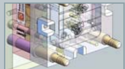
Zeichnungsansicht einer in SolidWorks konstruierten Spritzgussform von Kessler Werkzeugbau
