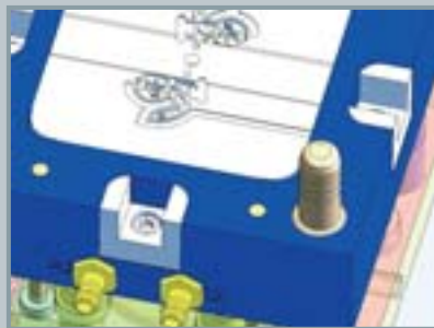
Eckdetail einer Spritzgussform
